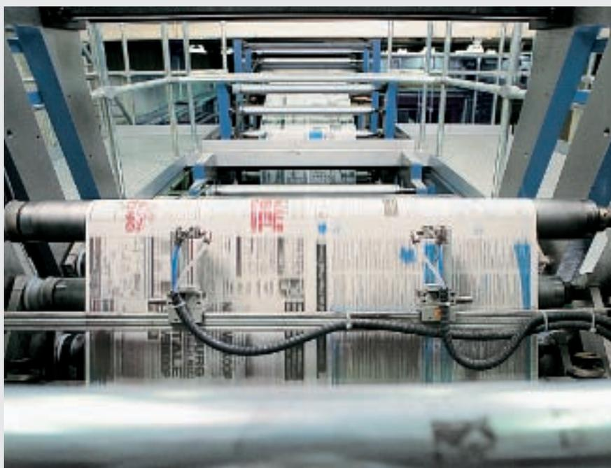
Entraînement direct par servomoteur des dispositifs d'appel dans la superstructure
