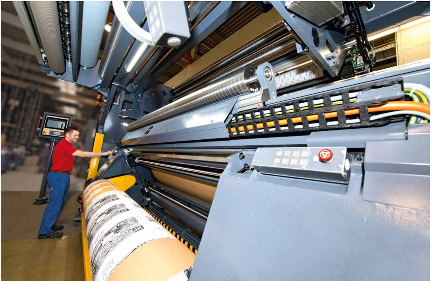
Rotative jet d'encre d'une laize de 2,8 m équipée d'un KBA Pastomat pour le marché de l'emballage
