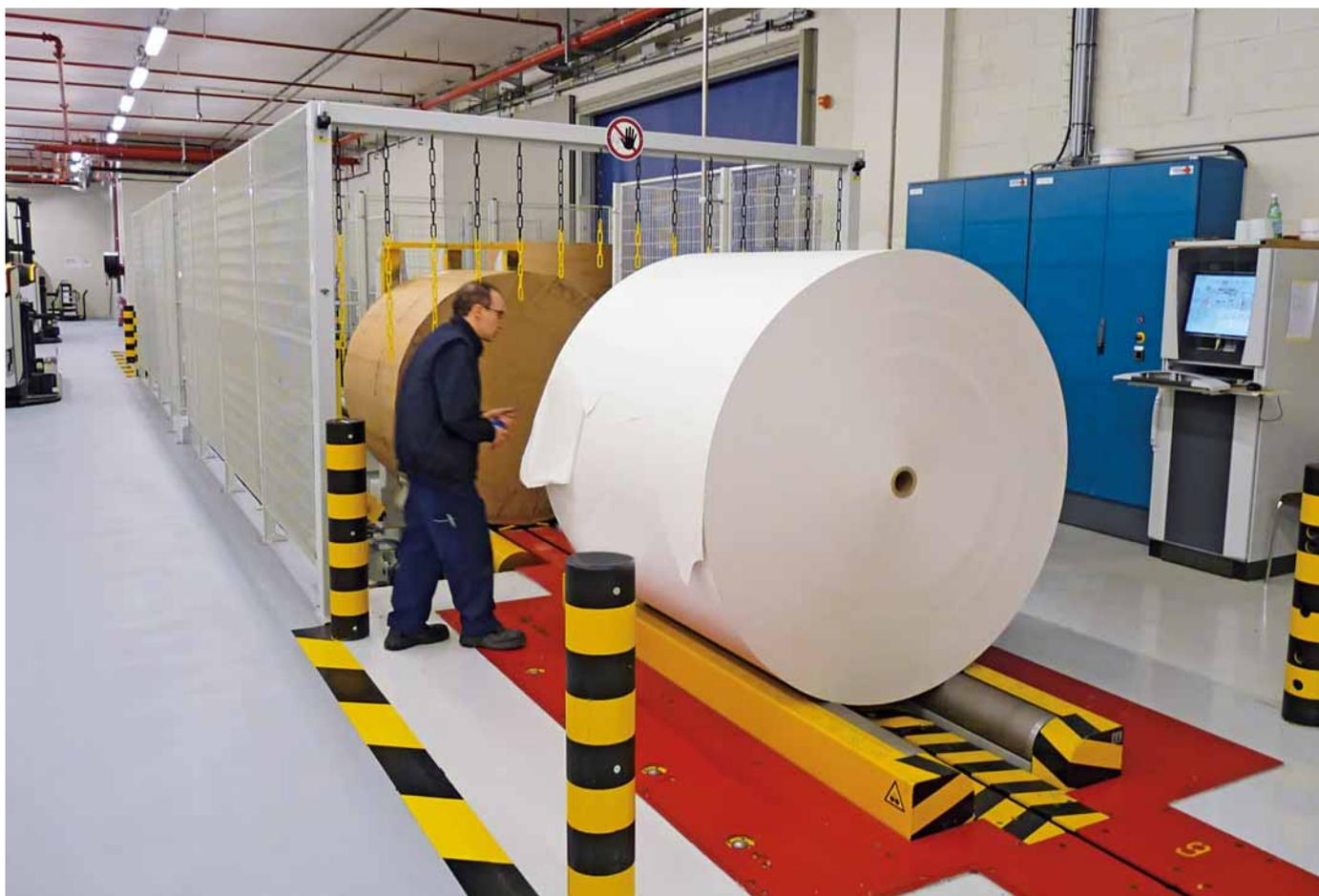
Poste de démaculage avec dispositif de pesée
