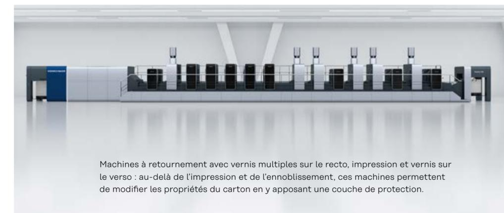
Machines à retournement avec vernis multiples sur le recto, impression et vernis sur le verso : au-delà de l'impression et de l'ennoblissement, ces machines permettent de modifier les propriétés du carton en y apposant une couche de protection.
