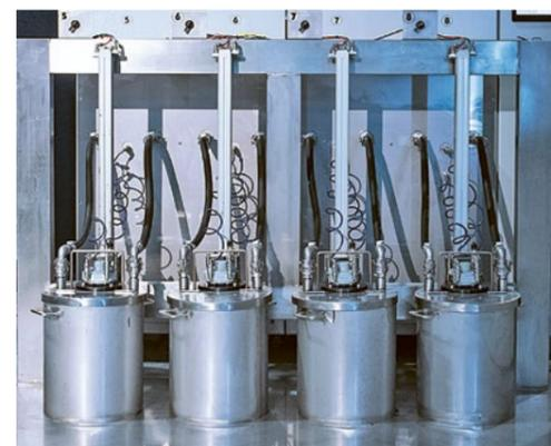
Le lavage automatique **"WashTronic"** avec gestion complète des séquences de lavage de panneaux "Touch Screen" pour les encres à base de solvant et à base d'eau permet de laver l'unité d'encrage de toutes les stations d'impression en quelques minutes seulement, ou juste celles sélectionnées par l'opérateur avec une consommation minimale de solvant ou d'eau.
