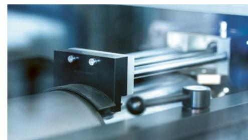
**Éjecteur pneumatique** sur la chemise et les chemises à imprimer anilox pour faciliter l'extraction de l'impression et des manchons anilox en toute sécurité, en évitant les égratignures ou les dommages, en particulier avec les grandes largeurs et les tailles d'impression.
