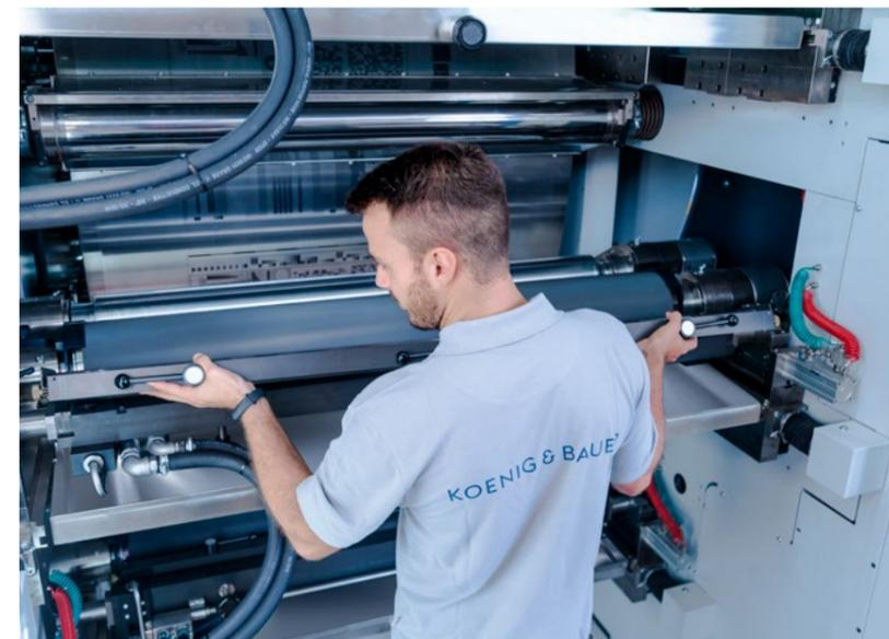
Nouvelle chambre à racle au design innovant par Koenig & Bauer Flexotecnica
