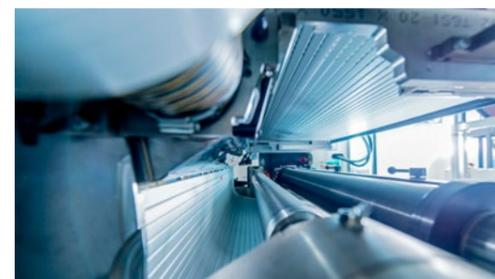
Le système breveté **"SSC" (Safe Sleeve System)** permet la préparation de certaines stations d'impression au repos pendant la production de la manière la plus simple et la plus sûre.
