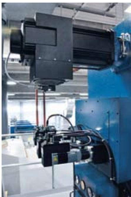
Chez KBA, les machines à double développement sont équipées depuis des années d'entraînements directs DriveTronic. Les moteurs AC sont asservis au process, ce qui signifie que la vitesse ou le couple sont variables et la consommation d'énergie réduite au strict minimum.
