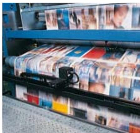
Mesurage et régulation de l'encre pour une impression parfaite
