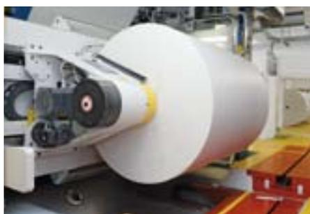
Entraînement des bobines de papier par le centre au moyen de moteurs AC robustes
