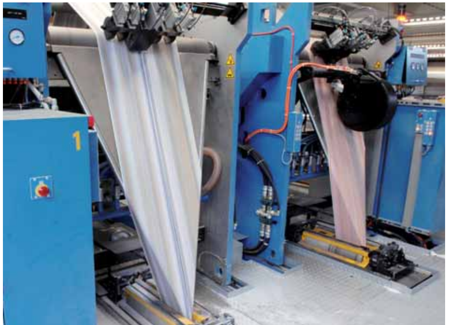
Ci-dessus : la technologie skip slitter (cône de droite) permet de diversifier encore la production
