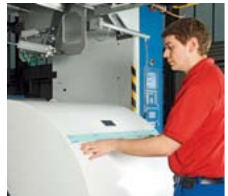
Changement de bobine automatique avec collage très sûr à pleine vitesse de la machine
