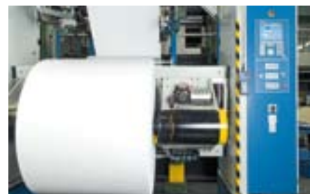
Les entraînements AC à entretien réduit situés dans les bras porteurs assurent l'accélération et le freinage des bobines
