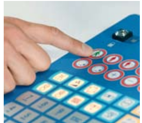
Accélération et arrêt automatiques faciles de la rotative par commande à bouton unique avec KBA EasyGo et EasyStop
